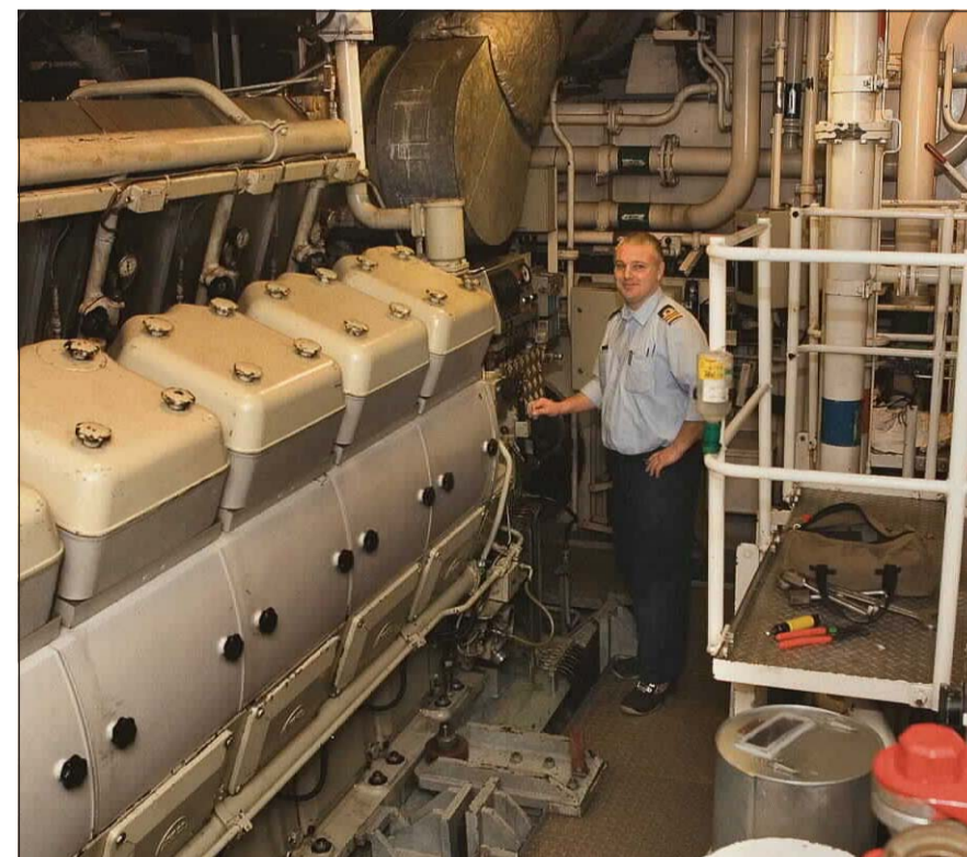
Brian Gadegaard har på Galathea den daglige ledelse af skibets tekniske division og har bl.a. ansvaret for driften af de tre MAN B&W Alpha motorer med 12 cylindre og 4000 heste hver.
